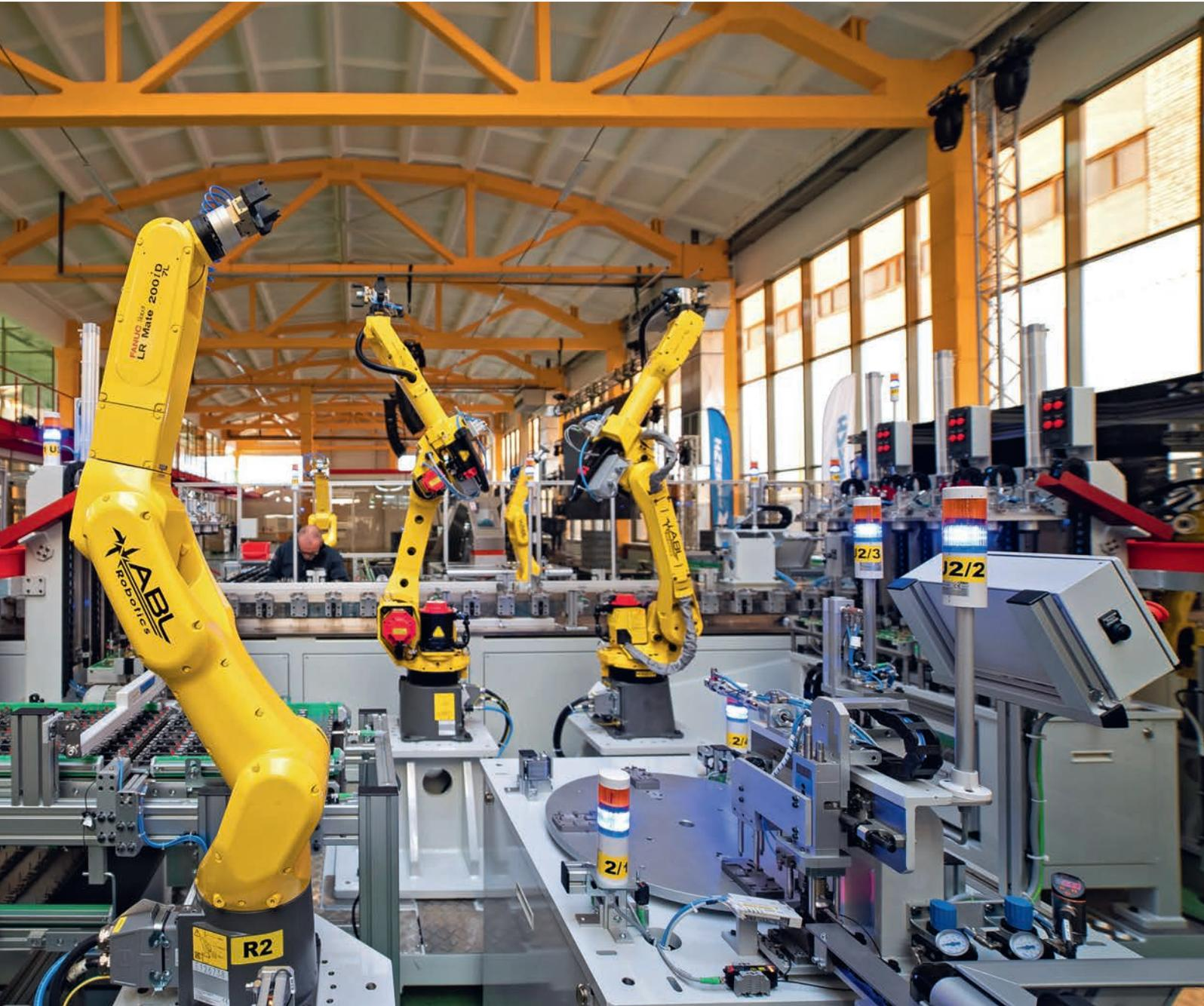
▲ Soprano — автоматизированная линия по производству пожарных датчиков компании RUBEZH
